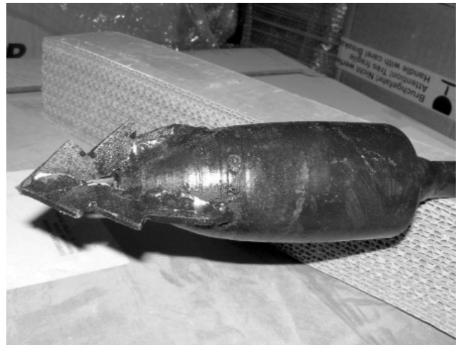
Рис. 13 Робоча насадка для руйнування пробки
